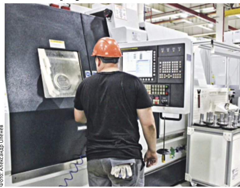
■ Если сотрудник вошел в рабочую зону без каски, то станок автоматически отключается
